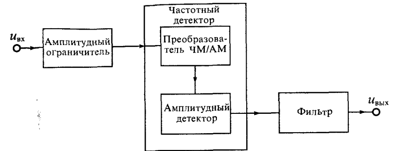
Рис. 25.7. Структурная схема частотного демодулятора
